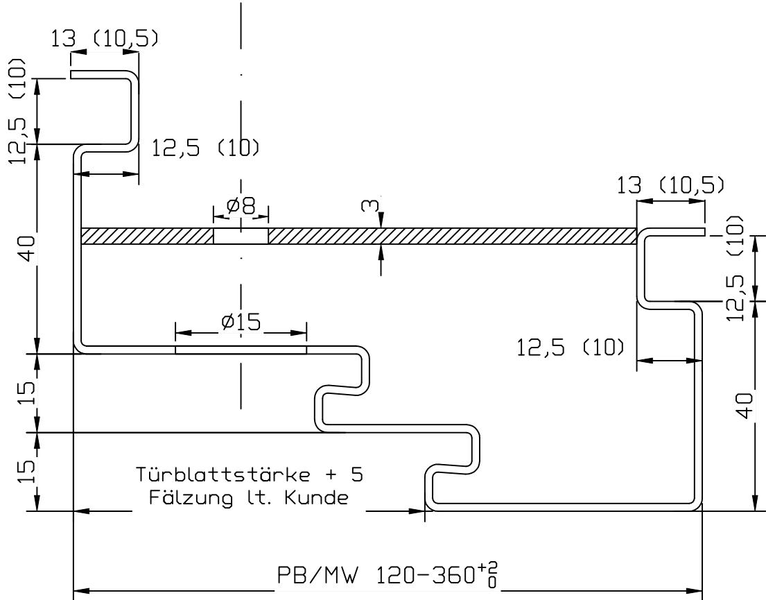
gedrückte Gummidichtung: 3mm
