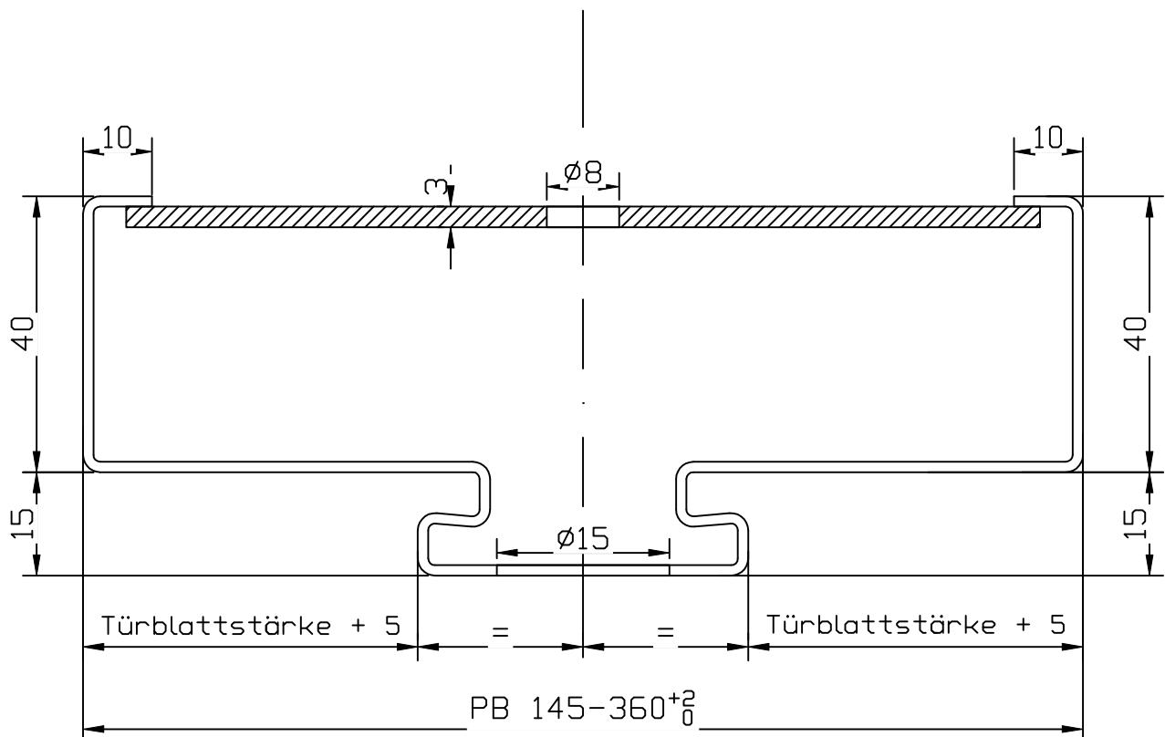
gedrückte Gummidichtung: 3mm
