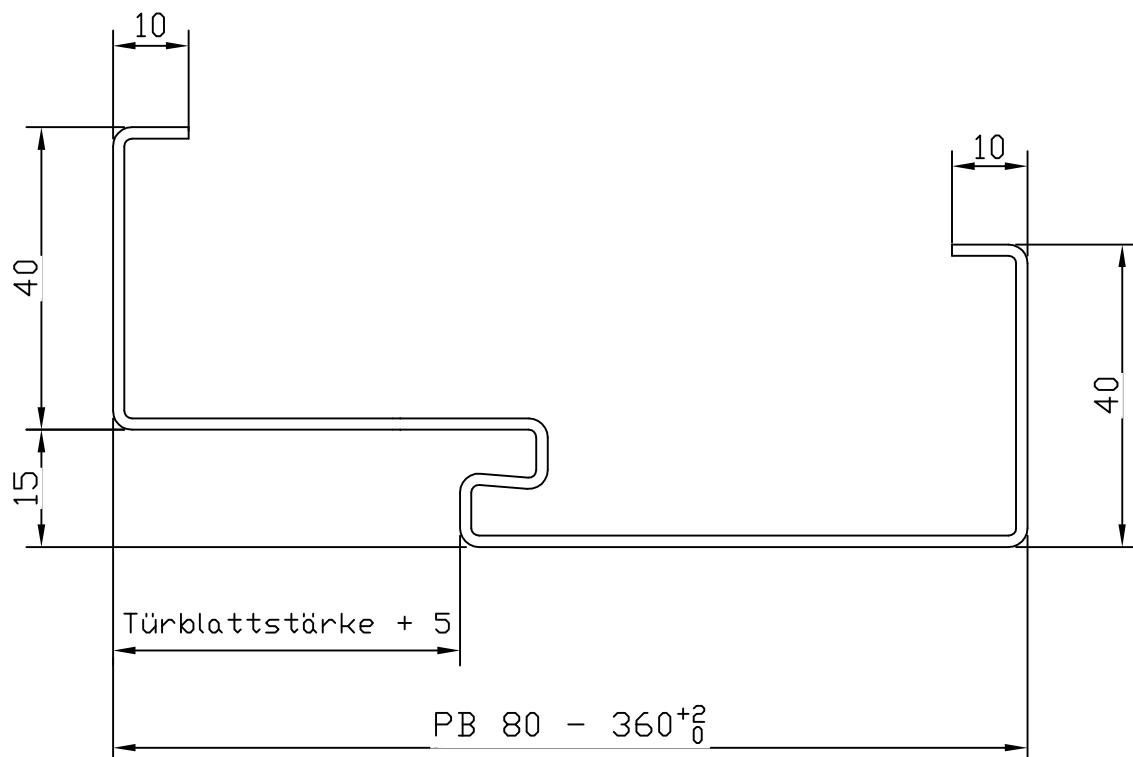
gedrückte Gummidichtung: 3mm
