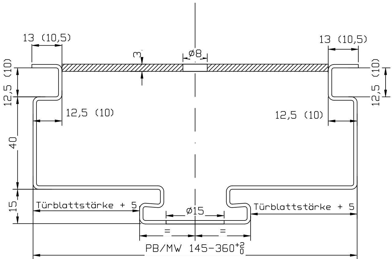
gedrückte Gummidichtung: 3mm
