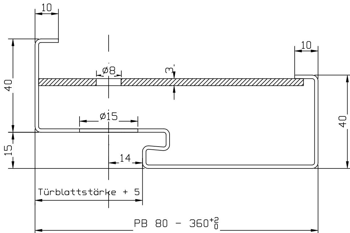
gedrückte Gummidichtung: 3mm
