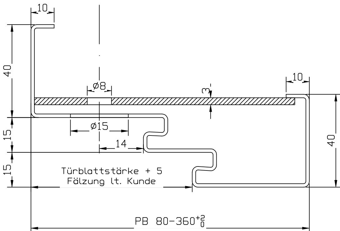
gedrückte Gummidichtung: 3mm
